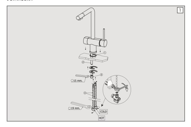
Разместите смеситель на поверхность мойки , вставив уплотнительное кольцо (1) и установите снизу комплект креплений. Затем навинтите крепежную гайку (3) на шток (2), зафиксировав, таким образом, смеситель . Подсоедините шланги горячей и холодной воды (4) к трубе водопровода.
