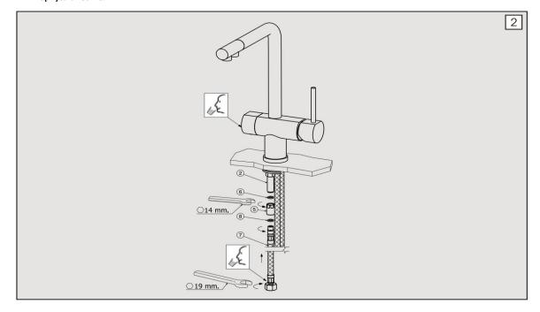
Завинтите гайку (5), надев на шток специальную прокладку (6). Гайку (5) навинтите на шланг очищенной воды (7), вставив специальную прокладку (8). Подсоедините шланг (6) к распределителю очищенной воды.
